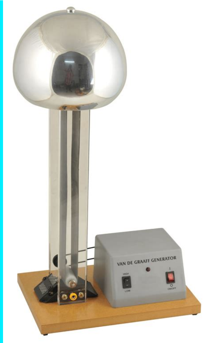
Photographie d'un générateur de Van de Graaff de démonstration
