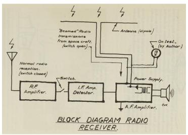
Voilà le montage modifié de la radio tel qu'il a été constaté, que Valdar avait effectué pour permettre aux Koldasiens d'annuler le circuit normal de réception radio et de transmettre par activation à distance et réception dans l'étage final.
